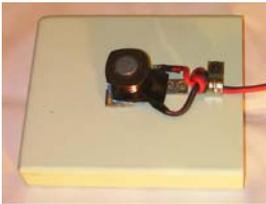
Da un relè ausiliario 12 V c.c per uso industriale è stata separata la bobina e rimosse numerose spire, fino ad ottenere un avvolgimento con una resistenza del filo pari a circa 20 ohm, misurabile con il multimetro (tester). La bobina è stata poi fissata ad una tavoletta di legno.
