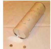
Dopo avere inserito le calamite dentro il tubo, esse si attaccheranno immediatamente al fondo di metallo. Si potrà ascoltare la musica proveniente da una radio accesa, collegando la bobina alla presa cuffie e appoggiando il tubo sulla stessa, con l'accortezza di tenerlo leggermente inclinato.
