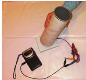
Dunque si realizzerà un dispositivo funzionante con lo stesso principio dell'altoparlante classico, diverso nella posizione reciproca degli elementi fondamentali: la bobina è fissa mentre il magnete è mobile.
