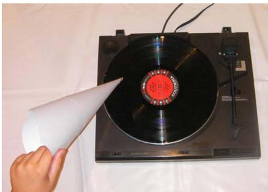
La rotazione del disco fa sì che la puntina generi vibrazioni derivanti dall'irregolarità del solco che, per mezzo dello stilo su cui è montata, vengono portate ad un trasduttore che le trasforma in un segnale elettrico molto debole; per l'ascolto con un altoparlante è necessario uno stadio di preamplificazione-amplificazione.
